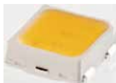
Encapsulado en Resina Termoplástica sintética (poliftalimida PPA)
