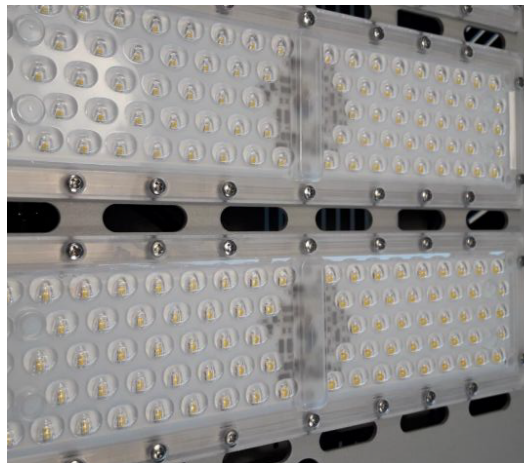
Figura 1- Módulo tipo con sus lentes secundarias expuesto a la intemperie y driver incorporado
