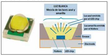
El LED de luz blanca, emitirá un flujo luminoso cuya temperatura de color TCC puede ser cálida, neutra o fría. La tensión aplicada y la corriente contínua determinará la potencia del LED que junto a la cantidad de flujo luminoso definirá la eficacia del LED.
