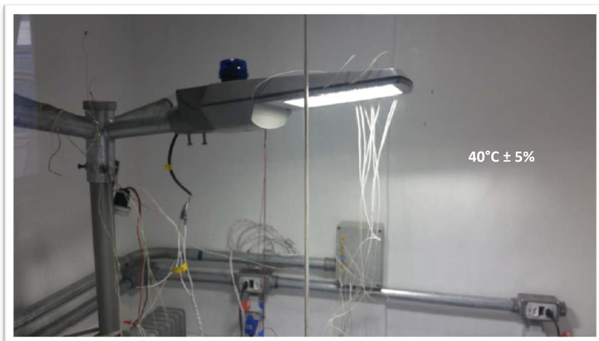
Luminaria NATH S bajo ensayo dentro de la cabina calefaccionada con temperatura ambiente controlada
